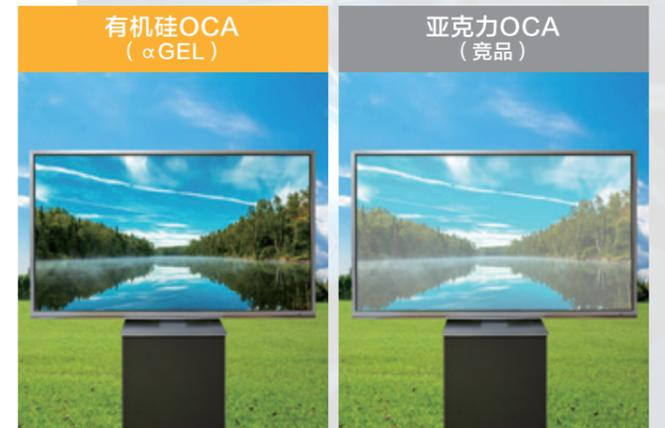
※此图片显示的是反射式显示屏在户外观察的效果。
